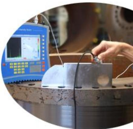
Figure 3 : Les ultrasons en laboratoire
