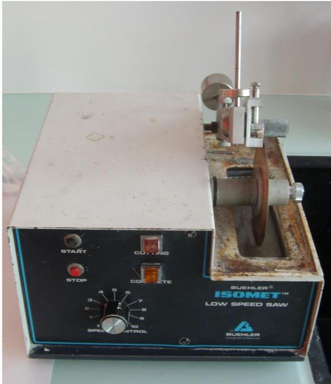
Découpe des échantillons avec une scie diamantée à vitesse lente Isomet 1000
