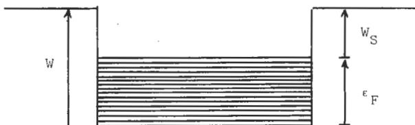
Fig. 9. — Puits de potentiel dû aux ions positifs du réseau métallique contenant les électrons libres.
