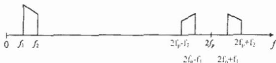
1.3.3- Il faut un filtre passe-bas laissant passer la fréquence  $f_2$  et éliminant la fréquence  $2f_p - f_2$ . Sa fréquence de coupure  $f_c$  est telle que  $f_2 < f_c \ll 2f_p - f_2$ , soit  $15 \text{ kHz} < f_c \ll 1 \text{ MHz}$ .
